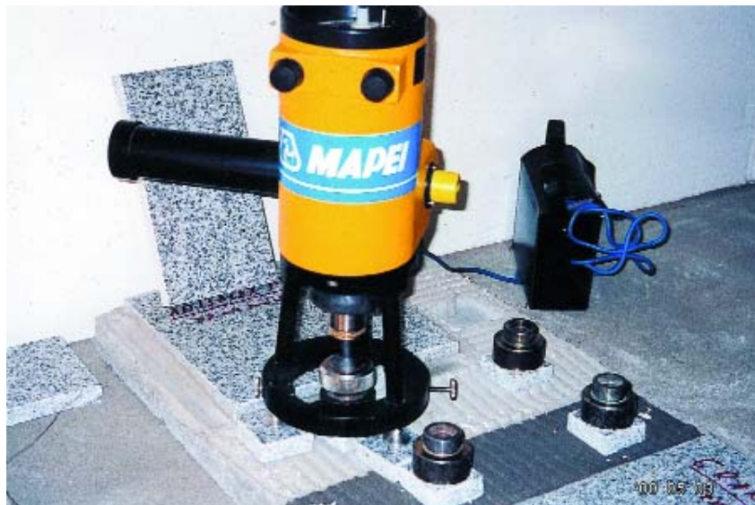
Természetes kövek tapadó-húzószilárdsági vizsgálata a „Freundl Easy M” tapadó-húzószilárdság vizsgáló készülékkel
