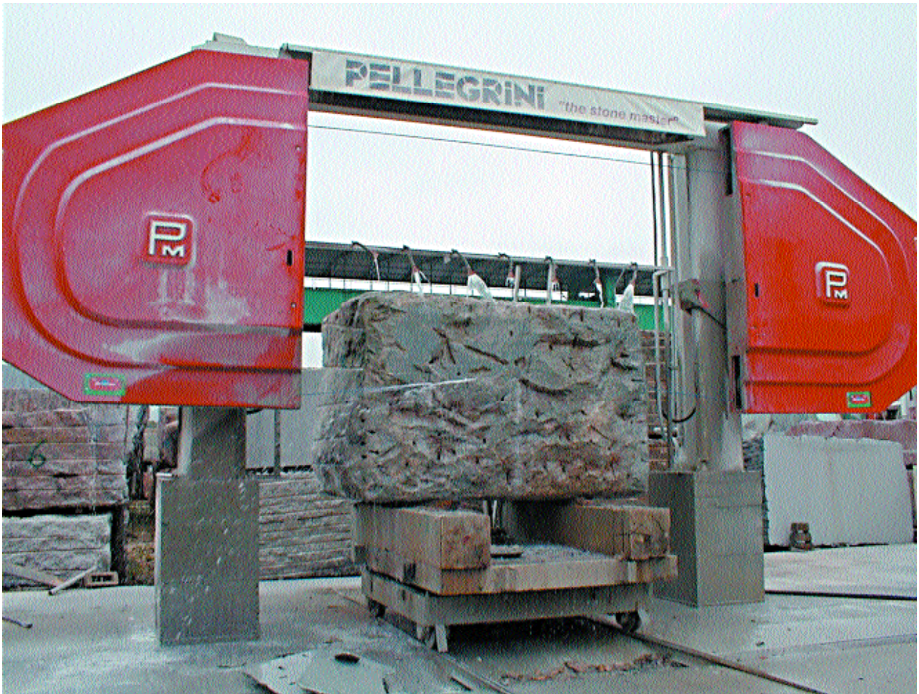
Tömb felvágása drótkötél-fűrészsel
